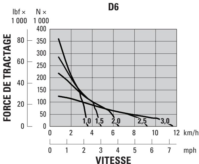
**NOTE :** La force de tractage utilisable dépend de la traction et du poids de la machine.
